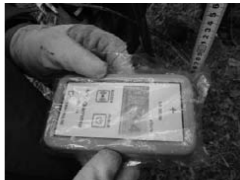
図-9 全方向からの空間放射線量率測定
