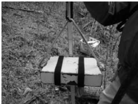
図-8 地表方向からの空間放射線量率測定
