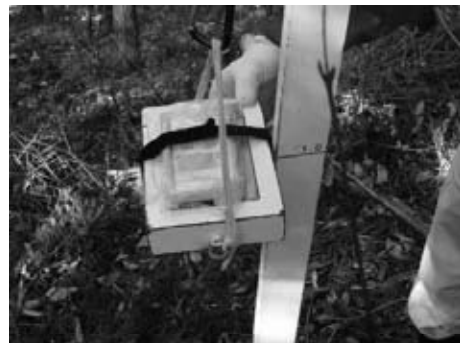
図-7 樹冠方向からの空間放射線量率測定
