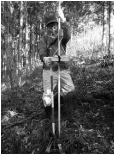
図-6 遮蔽台を用いた空間放射線量率測定
