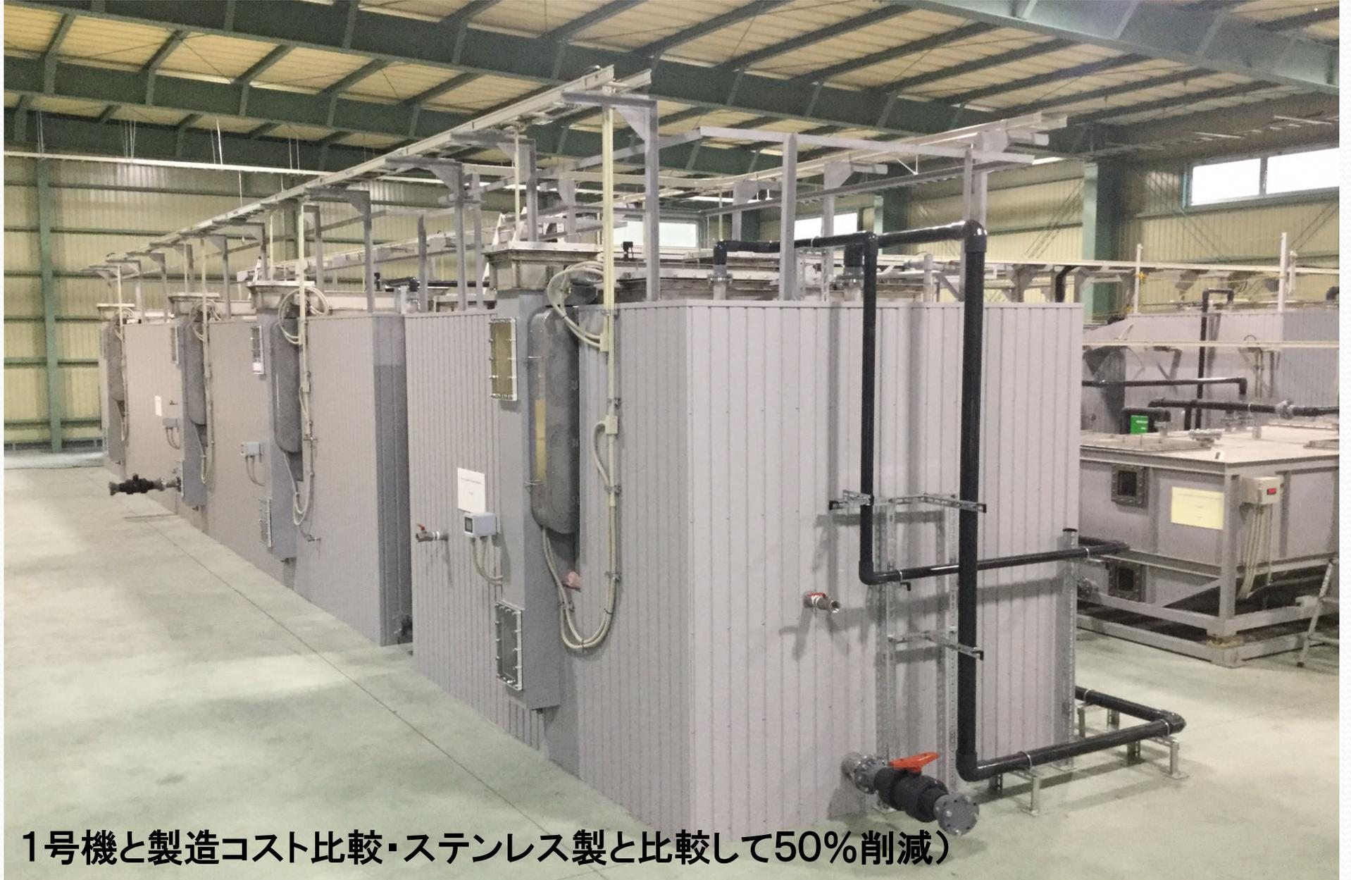
1号機と製造コスト比較・ステンレス製と比較して50%削減)
