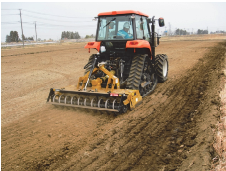
[パワーハローによる土壤改良資材の攪拌作業]
