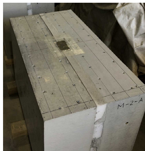
手順 5 : 止水材（モルタル）注入完了
