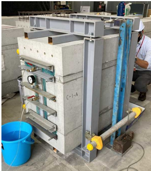
写真1. 試験体（加圧側）
