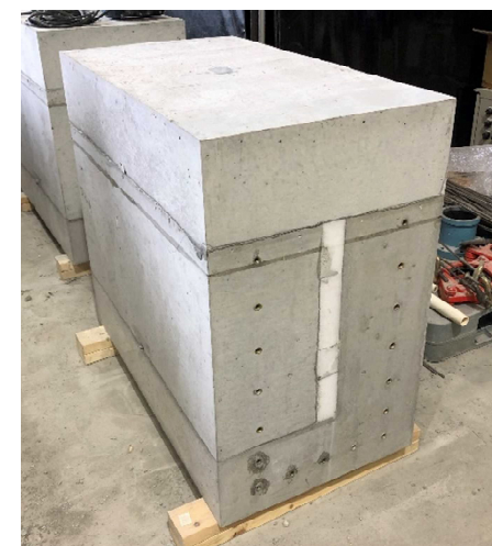
手順 6 : 上部設置（試験体完成）
