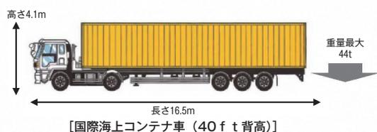
図4-2 国際海上コンテナ車（40 f t 背高）イメージ図
