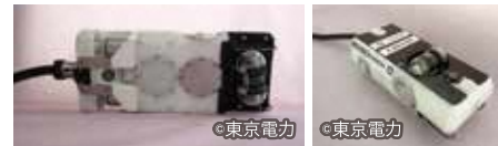
格納容器内を調査するロボットROV-A2
