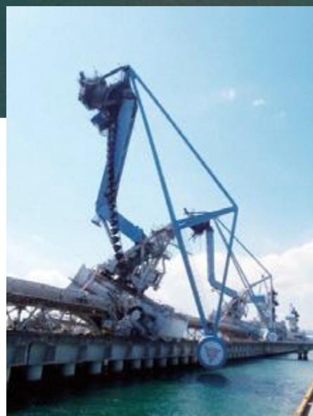
④ 相馬共同火力発電（株）の荷役クレーン倒壊
