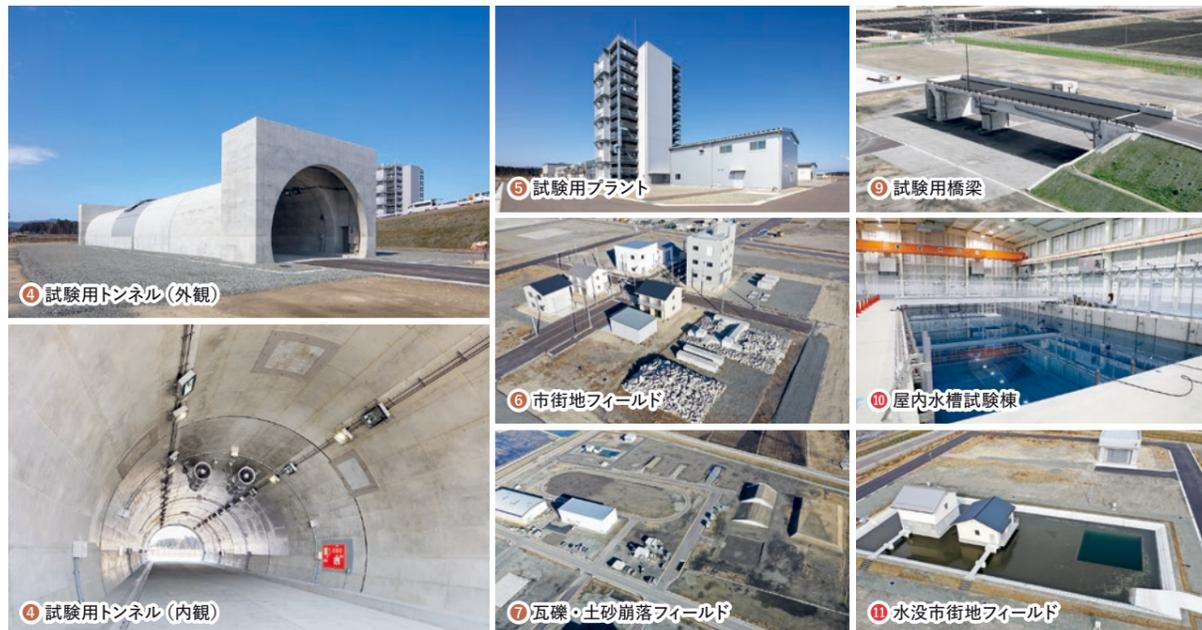
「福島ロボットテストフィールド」は、物流、インフラ点検、大規模災害などに活用が期待される無人航空機、災害対応ロボット、自動運転ロボット、水中探査ロボットといった陸・海・空のフィールドロボットを主対象に、実際の使用環境を拠点内で再現しながら研究開発、実証試験、性能評価、操縦訓練を行うことができる、世界に類を見ない一大開発実証拠点です。本拠点は、南相馬市・復興工業団地内の東西約1,000m、南北約500mの敷地内に「無人航空機エリア」、「インフラ点検・災害対応エリア」、「水中・水上ロボットエリア」、「開発基盤エリア」を設けるとともに、浪江町・棚塩産業団地内に長距離飛行試験のための滑走路を整備しており、2020年3月31日に全面開所いたしました。
