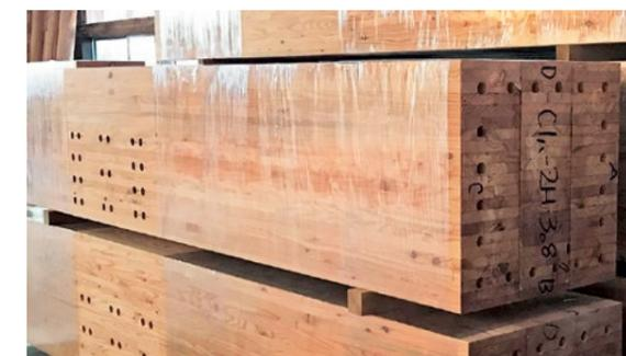
大型化が進む大断面集成材（二次接着部材）
