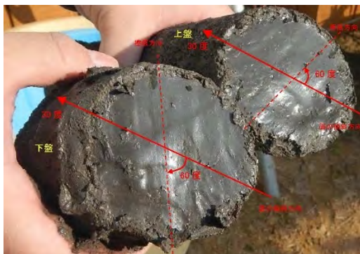
図-2.5.2 良質なボーリングコアの事例（庄内あさひ地区（山形県））
