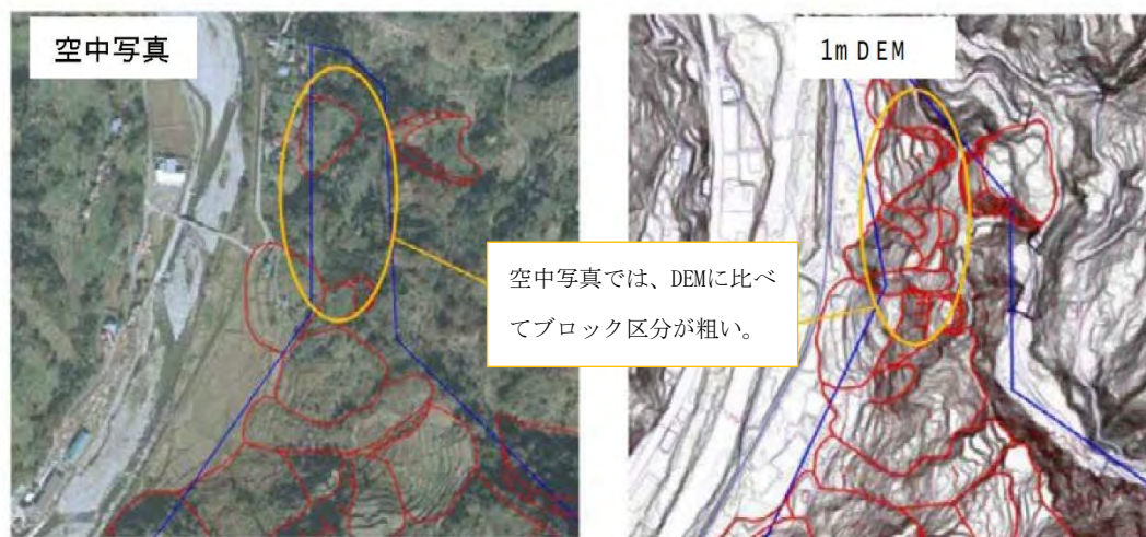
図-2.3.8 空中写真(左)と1mDEM傾斜分布図(右)の比較(杉林のため地形判読結果に差異)
