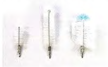
図-4.11.10 地元で開発された水抜きボーリング洗浄器具
