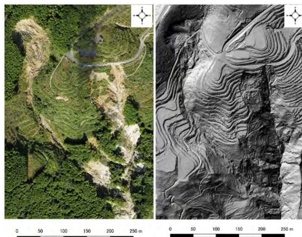
図-2.9.4 UAV測量によるオルソフォト図（左）と陰影図（右）の例
