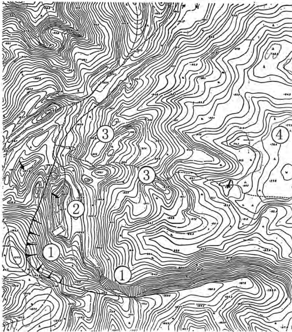
① 滑落崖 ② 凹地 ③ 分離丘 ④ 波状地形
