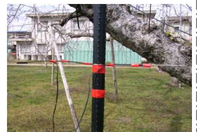
図2 温度センサーの設置方法
