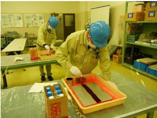
浸透探傷試験の実習
