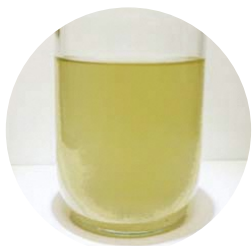
単独処理浄化槽の処理水
