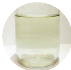
合併処理浄化槽の処理水
