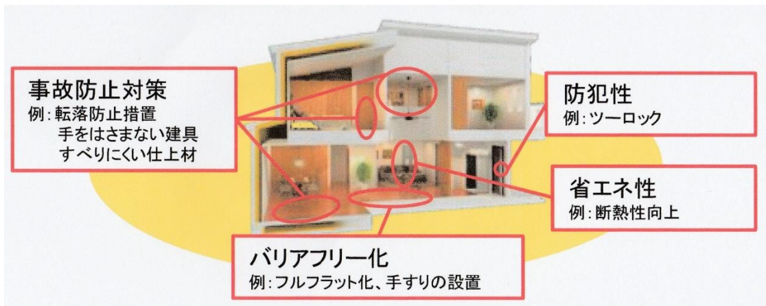
戸建て住宅を子育て仕様とする場合の改修例 (国土交通省社会資本整備審議会住宅宅地分科会資料)
