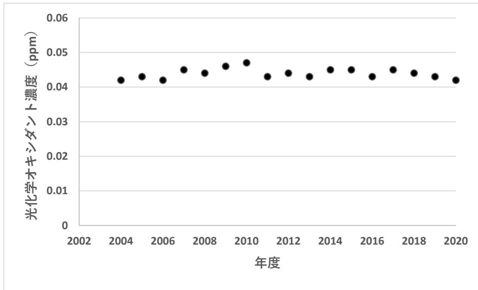
2 3 図 5-21 近年の光化学オキシダント濃度（昼間日最高 1 時間値の平均値）
