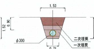
標準断面図 (支線排水路) 標準断面図 (小排水路)
