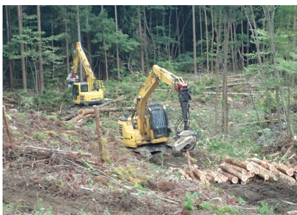
高性能林業機械による伐木造材
