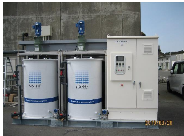
水産物の高鮮度保持技術の導入 (シャーベット氷製造装置)
