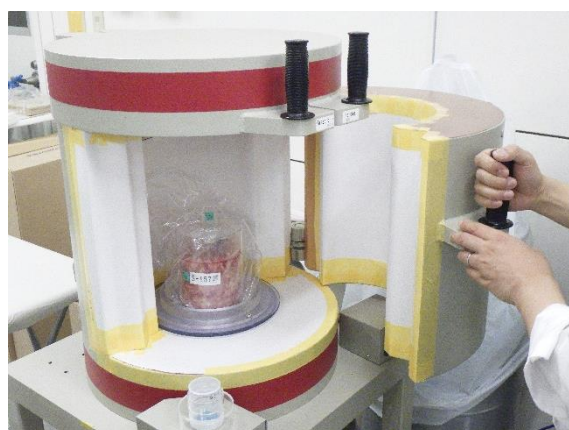
モニタリング検査を行っている機器 (ゲルマニウム半導体検出器)
