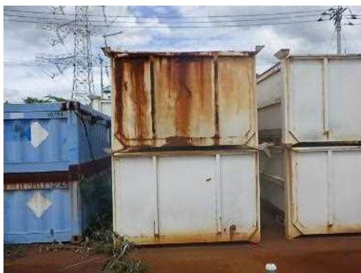
写真5.側面に著しい腐食があるコンテナ (5月26日撮影)
