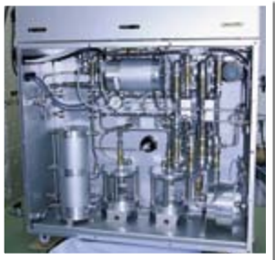
メタン改質装置。メタンから水素を発生させる
