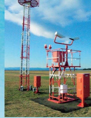
RVR観測装置 投光部及び受光部からなり、大気の透明度を測定して、滑走路中心線上の航空機の操縦席から灯火等を見ることができる最大距離を求めるために用いる装置です。
