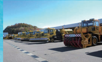
除雪車庫 滑走路、誘導路、エプロン等の雪氷を除去する機械を格納しておく建物で、ロータリー車2台、スノーバー車5台、プラウ4台、凍結防止剤散布車2台の計13台を配備しています。
