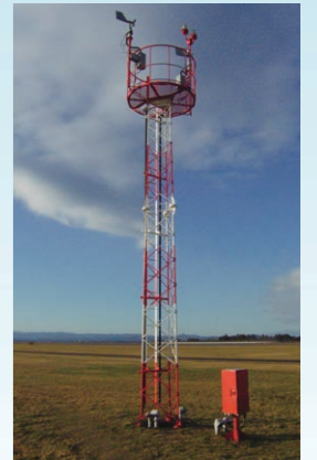
風向風速計 航空機離着陸付近の風向・風速を観測する装置です。
