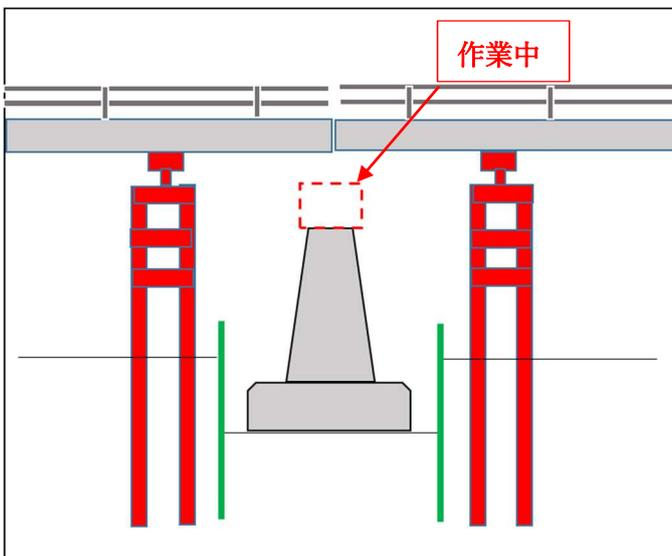
現在は橋脚の橋桁を支える土台を造っており、工事の進捗率は、計画どおりの**68%**（R3.3末時点）となっております。
