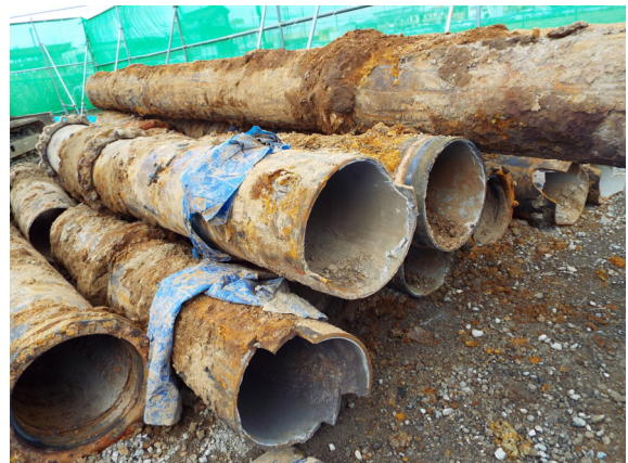
更新時に撤去された管路
