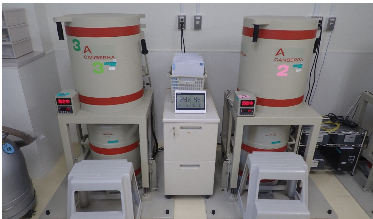
飲料水の放射性物質モニタリング検査に使用されているゲルマニウム半導体検出装置などの検査機器
