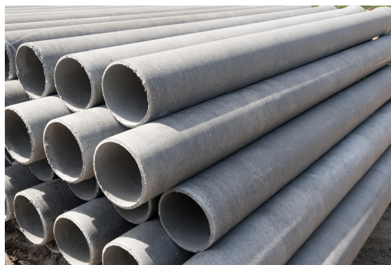
石綿セメント管
