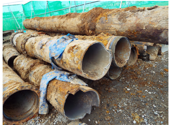
更新時に撤去された管路
