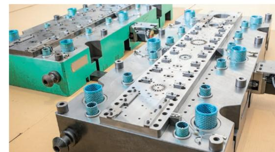
積層加工に使用する順送金型の例
