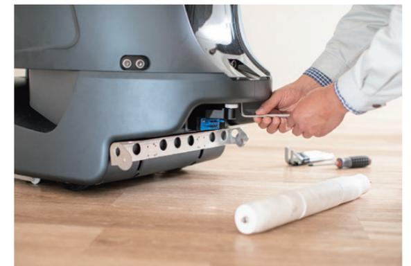
サービスロボットの組立・調整作業シーン
