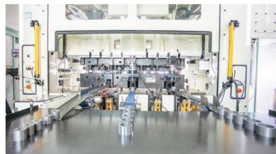
高速プレスによる積層加工シーン
