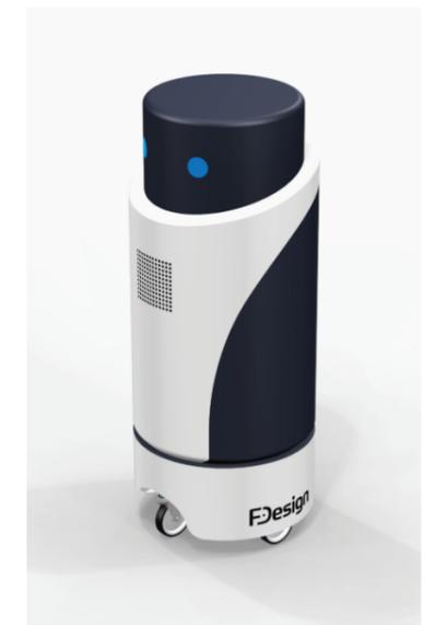
サービスロボットの例（警備ロボット）
