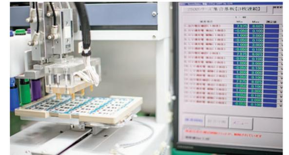
制御基板（保護回路）の導通検査シーン
