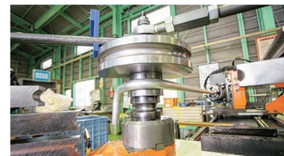
ベンダーによるアルミニウム管製品の曲げ加工シーン
