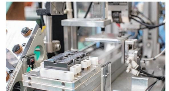
リチウムイオン電池パックの通電検査シーン
