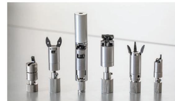
「立体カム機構」と「クラウン減速機」を応用したロボットハンドの例
