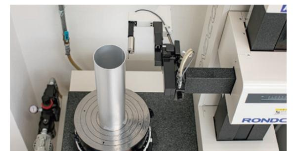
アルミニウム管製品の検査シーン（真円度測定）
