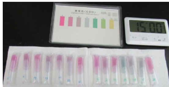
図1 地力窒素簡易評価法の測定の様子（一斉発色・一斉測定）
