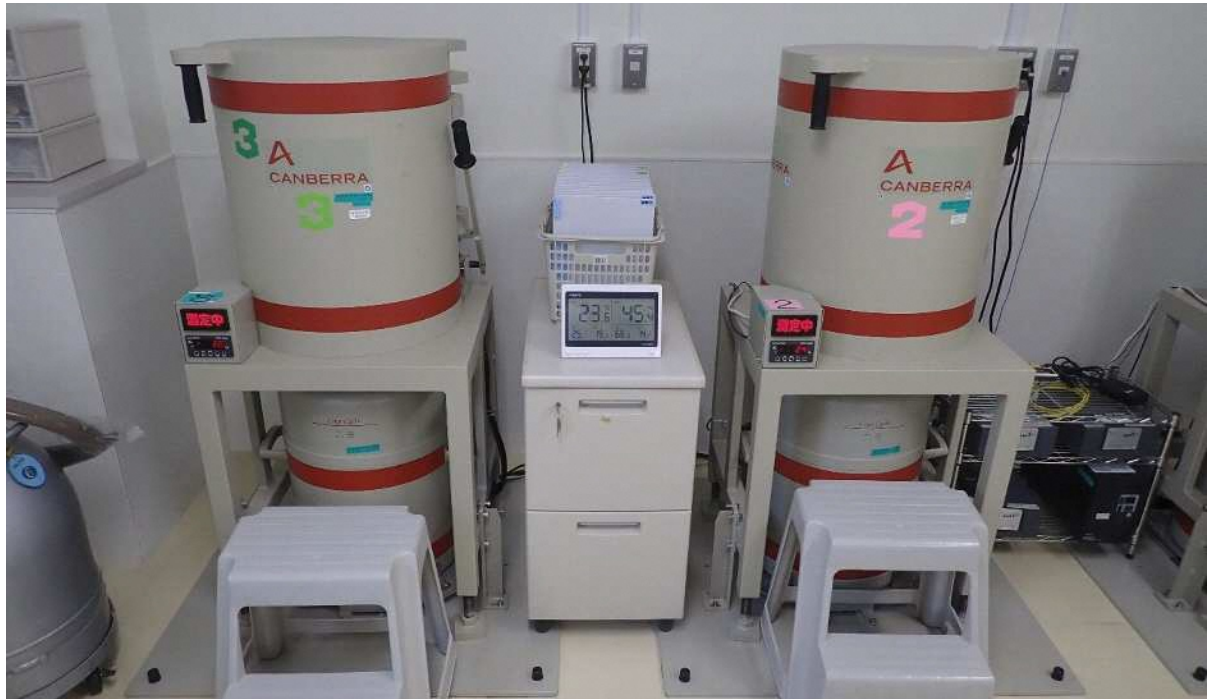
1 2 飲料水の放射性物質モニタリング検査に使用されているゲルマニウム半導体検出装置などの検査機器
