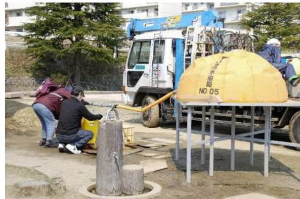
東日本大震災時の応急給水の状況（風船式給水槽）
