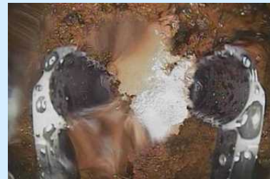
ペDESTAL内堆積物の把持状況
