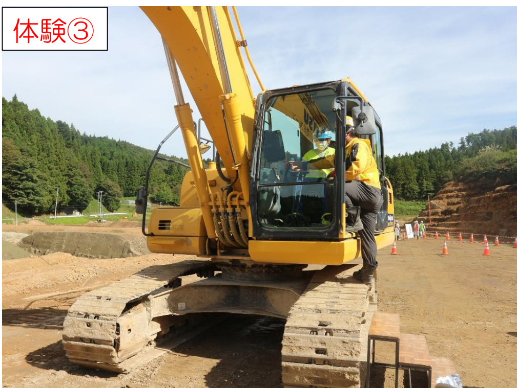
【ICT建機試乗体験】 ◆車載モニターでショベルの位置が確認できる建機に試乗しました。
