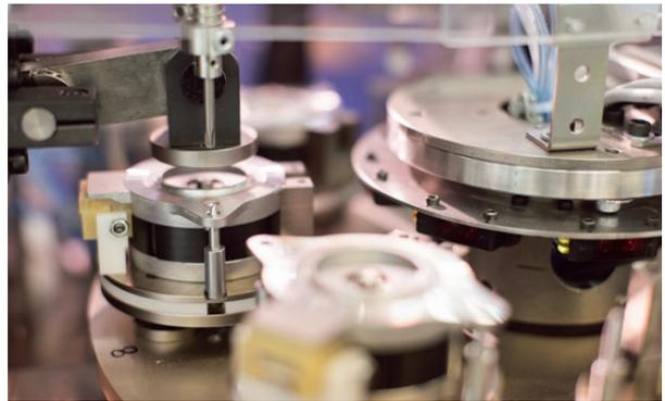
自製のターンテーブル式の自動検査装置
