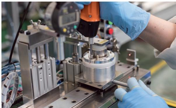
モーター式ガス遮断弁の組立工程
