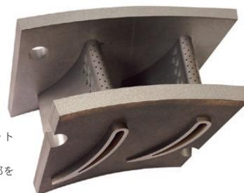
細穴放電加工、ワイヤーカットMCによる加工サンプル▶
