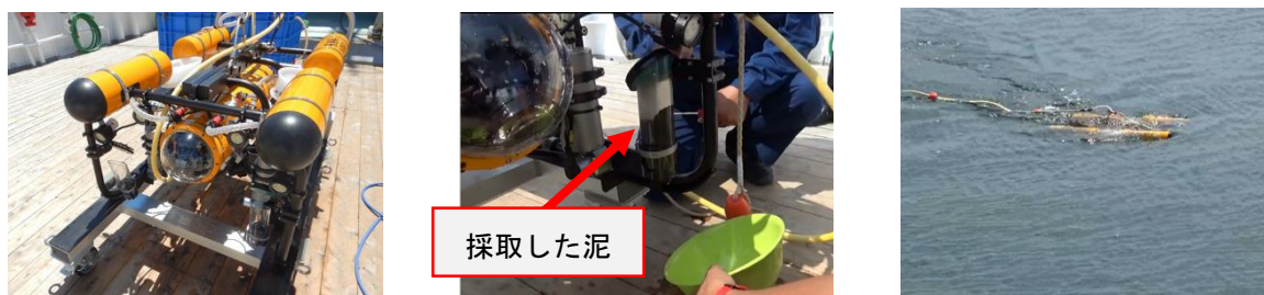
図3 ROV を用いた調査の様子 (左:船上の ROV, 中:採泥後, 右:海水中の ROV)
