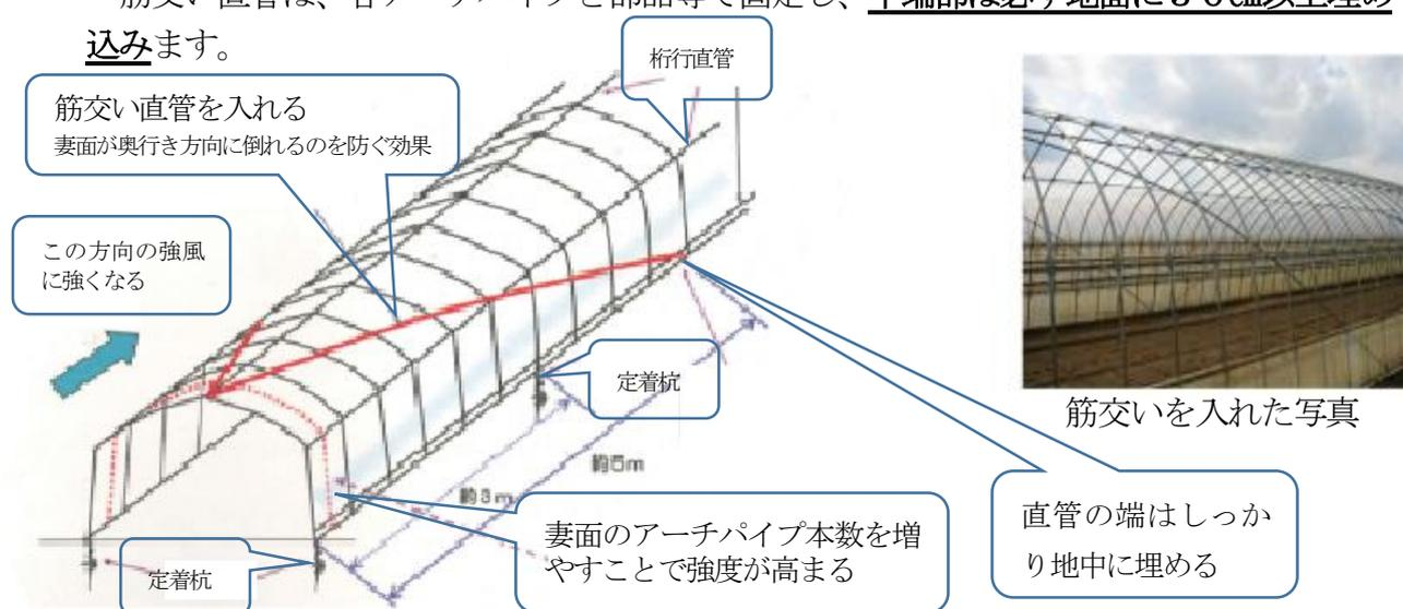
(筋交いによる妻面の補強方法事例)
