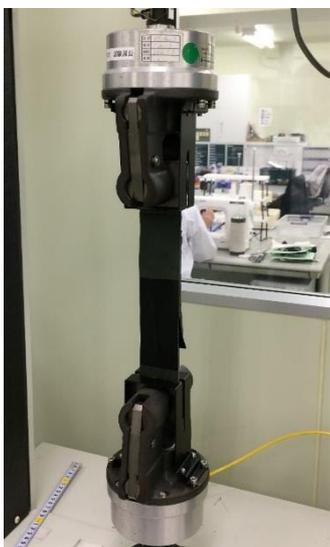
図 5-20 通気性防水シートの引張試験
