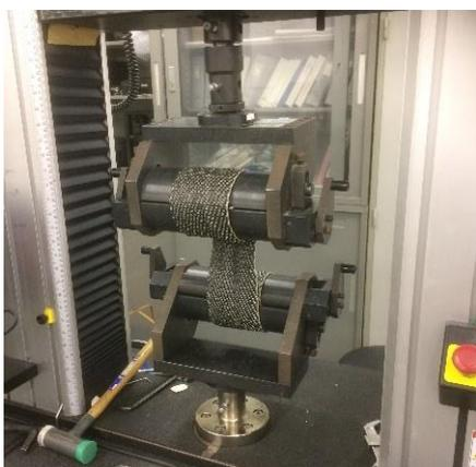
図5-18 吊ベルトの引張試験の様子
