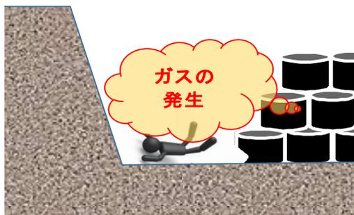
図 5-8 地下型・半地下型の場合の事故例(2)
