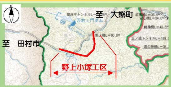
国道288号大熊町野上地内（野上小塚工区）では、道幅の狭い場所や急カーブ、急勾配の区間を解消するために、トンネルや橋りょうなどのバイパス工事が行われています。現在はトンネルを掘るための準備工事を進めています！
