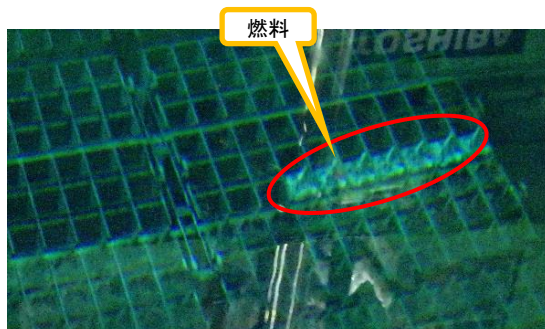
(写真17) 燃料ラックへ収納された燃料7体
