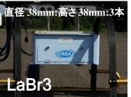
測定高度:50m程度、測線幅:50m程度、測定速度5m/s
