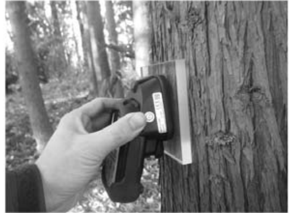
写真 野外における GM 管式サーベイメータ (RadEye-B20) を用いた測定状況 (左: 正面、右: 側面)
