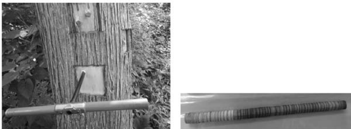
図-11 成長錐を用いた立木からの材の採取状況(左図)と、採取したサンプル(右)
