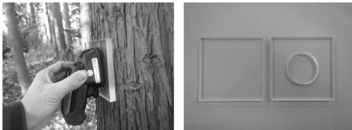
図－1 野外におけるGM管式サーベイメータ（RadEye-B20）を用いた測定状況（左）と、アクリル板（右）
