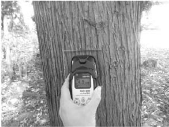
写真 野外における GM 管式サーベイメータ (RadEye-B20) を用いた測定状況 (左: 正面、右: 側面)
