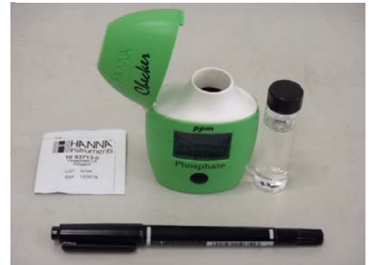
図1 調整済み発色試薬(左)と簡易吸光度計(中央)及び専用ガラスセル(右)
