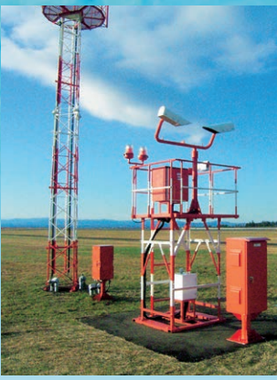
RVR観測装置 投光部及び受光部からなり、大気の透明度を測定して、滑走路中心線上の航空機の操縦席から灯火等を見ることができる最大距離を求めるために用いる装置です。
