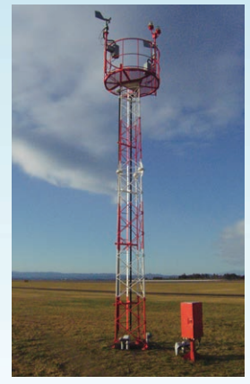
風向風速計 航空機離着陸付近の風向・風速を観測する装置です。
