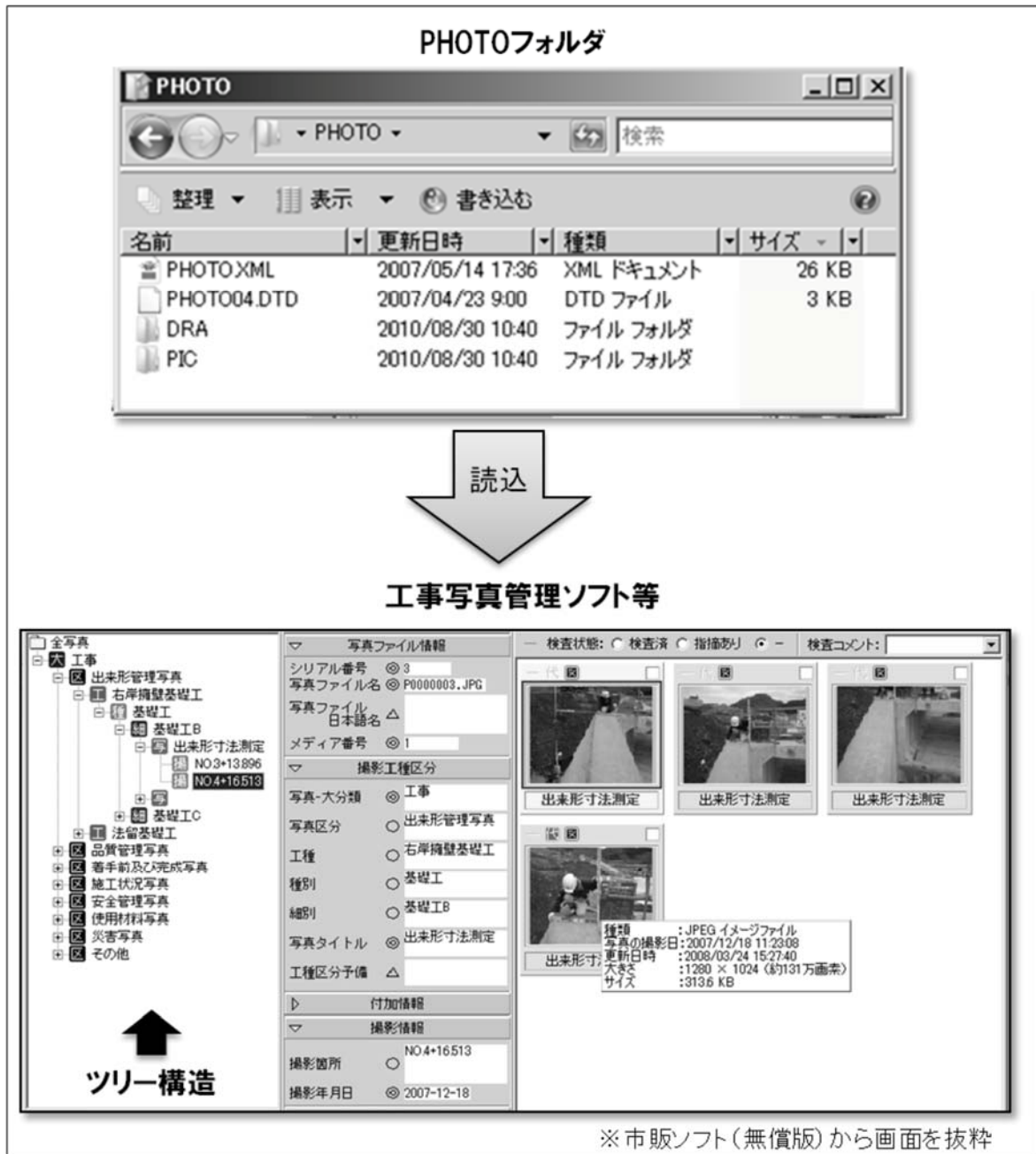
図 17 工事写真の電子検査 (イメージ)
