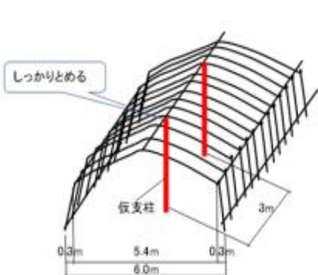
中柱（仮支柱）による補強事例
