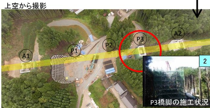
1 (仮)内倉1号橋では、P1・P2橋脚の基礎杭を施工しています。A1・A2橋台、P3橋脚は躯体が立ち上がっています。
