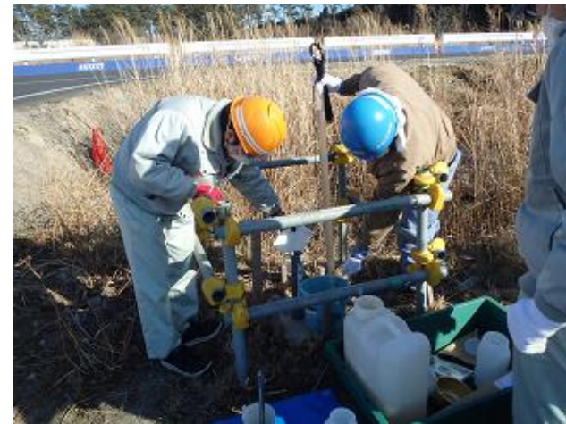
双葉工区保管場における地下水の測定
