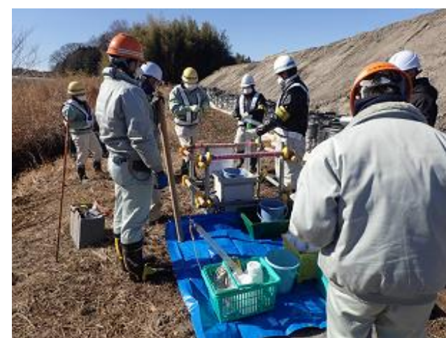
土壌貯蔵施設の下流側地下水の測定
