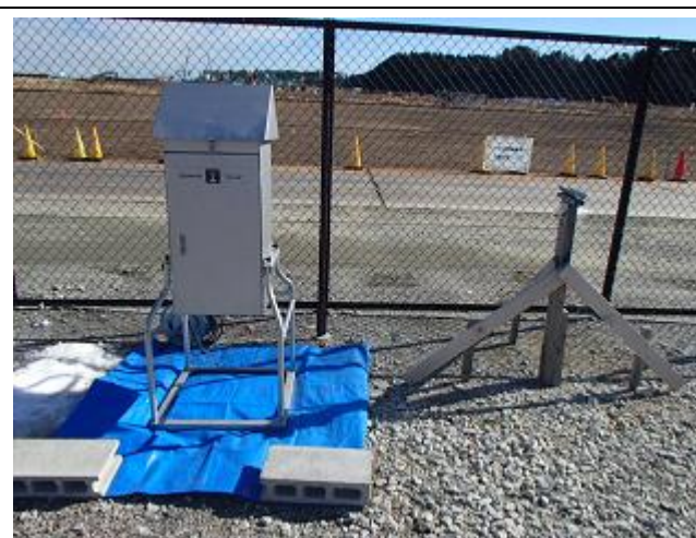
受入・分別施設における大気浮遊じんの測定
