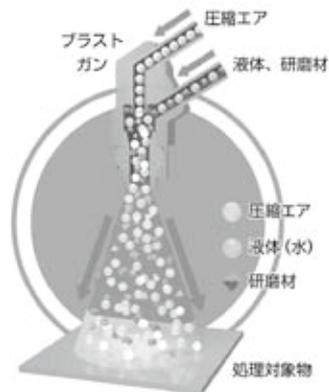
図-11 ウェットブラスト処理装置(左)、ウェットブラスト処理(右)
