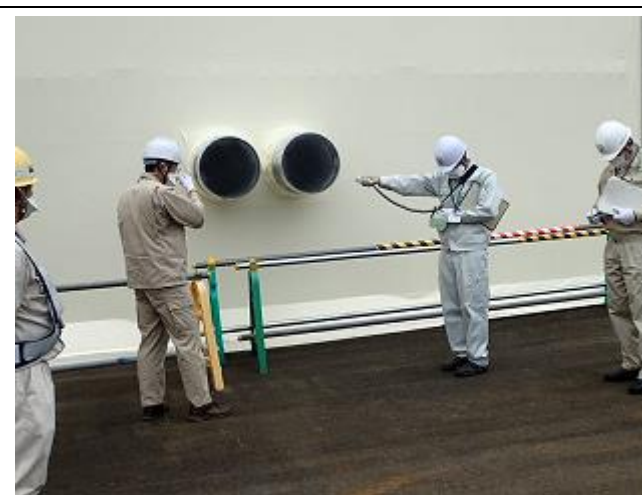
除じん機排気口付近での空間線量率測定
