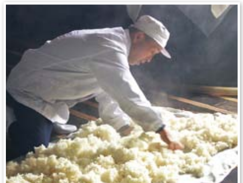
▲酒のもととなる酒母の仕込用の蒸し米を冷ましてるところ。手に伝わる感覚をもとに微妙な温度を調整します。
