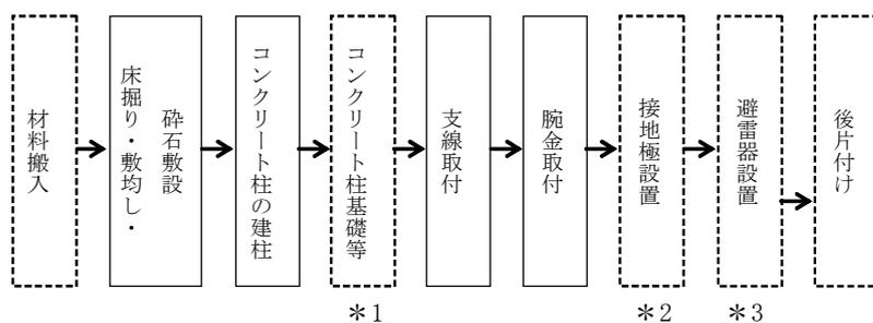
\*1 は、根入れが満足しないなど補強する場合及び鋼管ポールなどによるベースプレート式の場合とし、「第2章第1節⑬3-11 作業土工（電気）」による。
