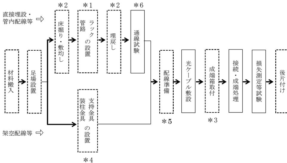
\*1は、屋内・屋外管路の敷設は、「第2章第1節①配管・配線工」及びラック設置は、「第2章第1節②配線器具設置工」による。
