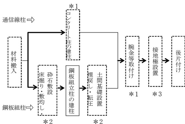
\*1は、「第2章第1節⑧引込柱設置工」による。
