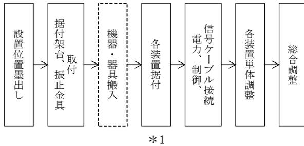
\*1は、同一室内各装置間の各種ケーブルの敷設を含む。
