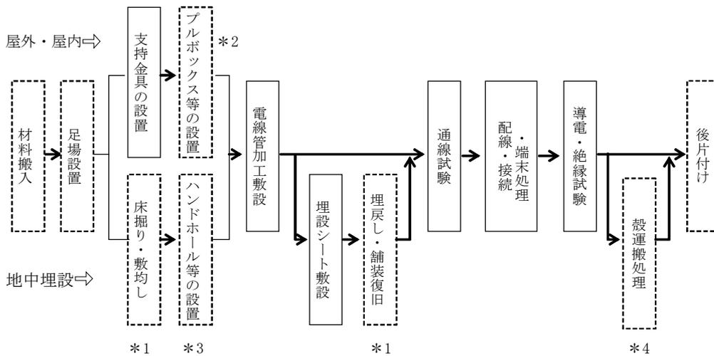
\*1は、「第2章第1節①3-11 作業土工（電気）」による。なお、床掘時に舗装があればとりこわしを計上する。
