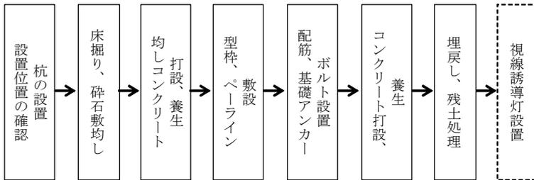
本作業は、第3章第5節①配電線設備設置工 3-10 作業土工（電気）による。
