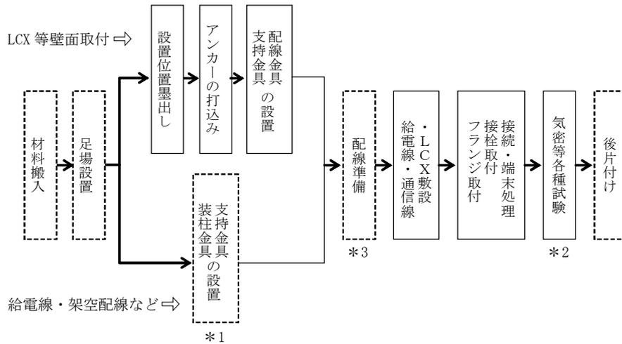
\*1は、架空配線については、「第2章第1節⑧引込柱設置工（腕金取付）」による。
