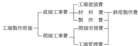
(注) 工場管理費の対象額は直接工事費と間接労務費の和であり、詳細は「土木工事標準積算基準書第IV編第7章①鋼橋製作工」によるものとする。
