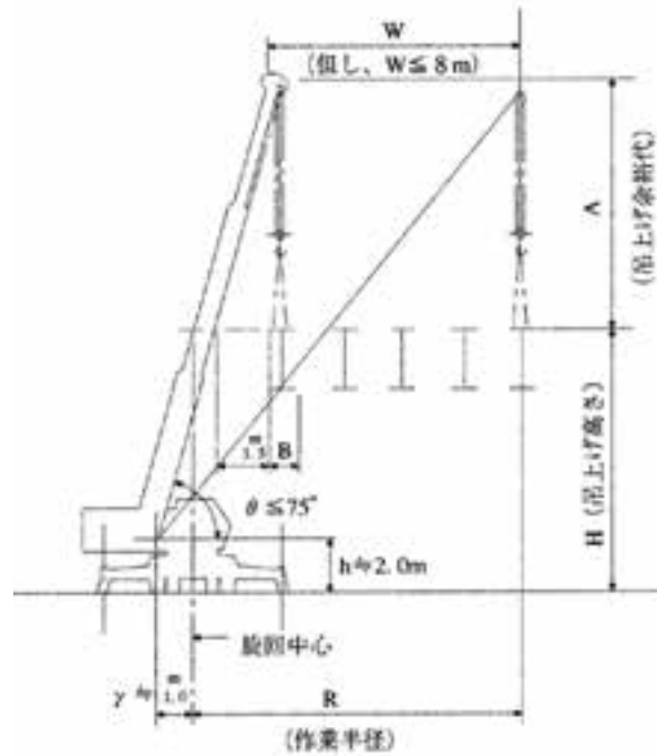
図18.2 作業半径概略図・鉸桁(移動式クレーン油圧伸縮ジブ型)
