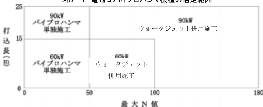
図3-1 電動式バイプロハンマ機種を選定範囲
